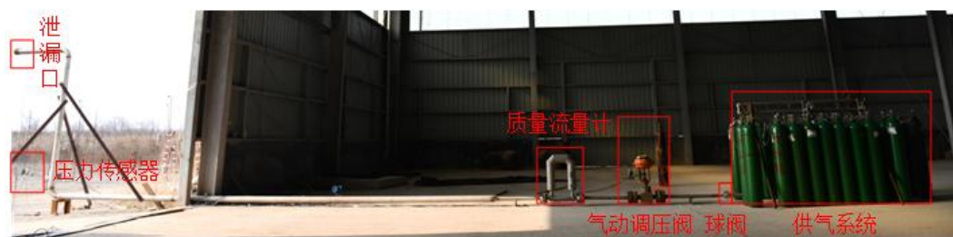
图 7 掺氢天然气喷射火实验装置
